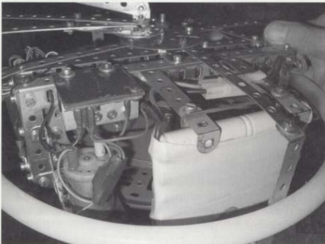
Foto 10 Op deze foto is de ophanging van het batterypack goed te zien
