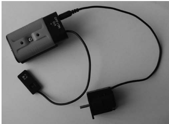
Linksboven is de batterijhouder met aan/uit knop. Daaronder is de infrarood sensor. Rechtsonder de 6V motor. Motor en batterij houder zijn gekoppeld door een stekker verbinding, terwijl de sensor een vaste verbinding heeft met de batterijhouder.
