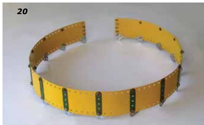
brede samengestelde buigzame sluitplaat foto 20 op afstand gehouden door de 8 dubbele hoekstroken nr. 48a aan de flensring nr. 167b van de basis foto 02 .
