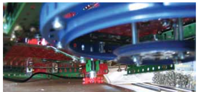
Het tandwiel 27f voor het zwenken van het kraanhuis is hier te zien.
