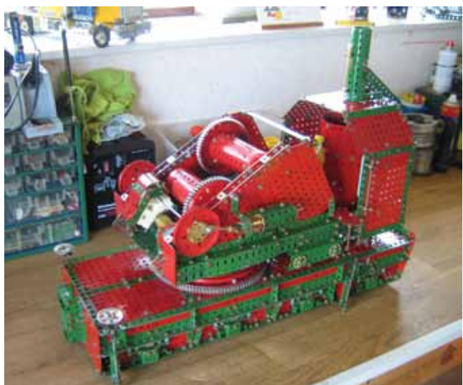
Hier is de aandrijving van één der cilinders te zien.
