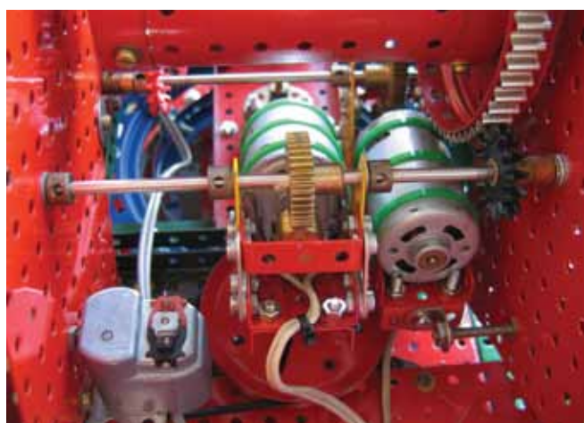
Hier is de overbrenging op achterste trommel. Ook is de Märklin ring met tandkrans te zien.
