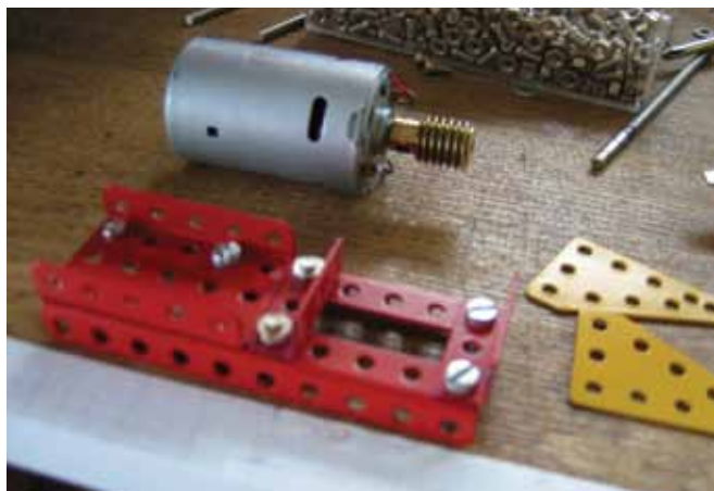
Één van de motorgondels, twee platen en een motor met wormwiel.
